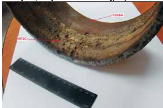
Рис. 1. Сталь 13ХФА и 09Г2С после восьми месяцев эксплуатации в условиях ООО «РН-Пурнефтегаз»
